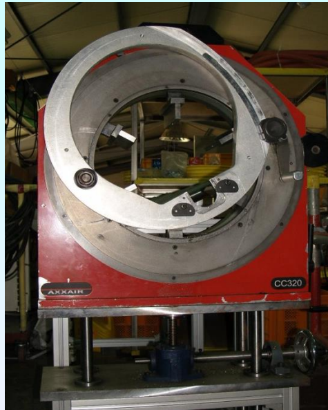
X.O CUTTER - 150A ~ 300A 사이즈 의 파이프 를 CUTTING 함.
