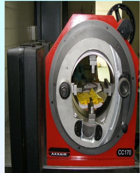
X.O CUTTER - 15A ~ 250A 사이즈 의 파이프 를 CUTTING 함.
